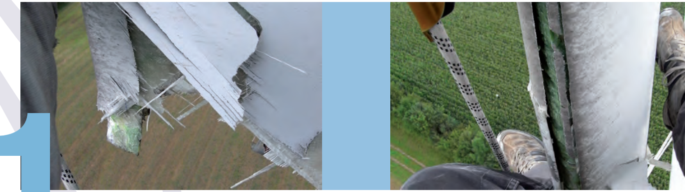
Schaden an der Rotorblattspitze
